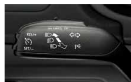
Tempomat pro všechny motorizace (5J1 035 623 pro vozy bez palubního počítače, 5J1 035 623A pro vozy s palubním počítačem)
